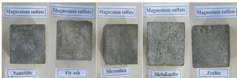
تصویر شماره ۴: بررسی تغییرات ظاهری نمونه ها تحت اثر سولفات منیزیم
