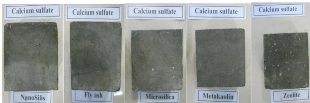
تصویر شماره ۵: بررسی تغییرات ظاهری نمونه ها تحت اثر سولفات کلسیم
